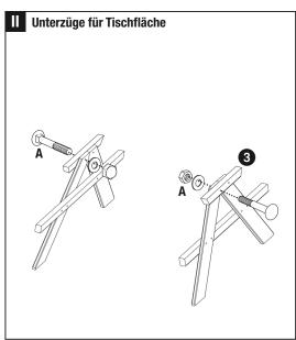
Trocknungsbedingt kann es sein, dass Bohrungen nicht genau überein passen. In diesem Fall bohren Sie die Löcher mit 6 mm nach.
